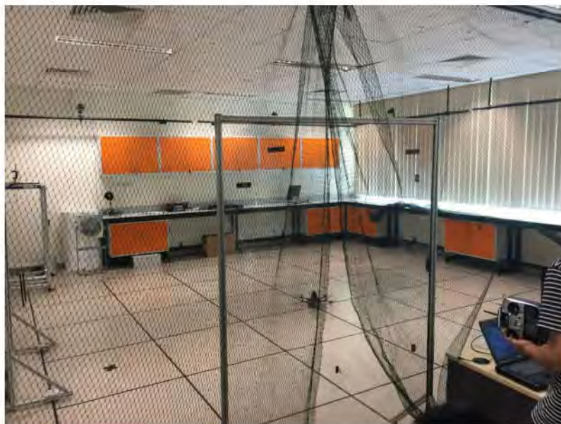
Слика 9. Соба за тестирање на летање во затворен простор со ViCon
